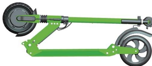
9. Den Haken am hinteren Kotflügel einrasten lassen. Der Roller ist jetzt zusammengeklappt!
