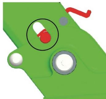
4. Lenkstange nach vorne drücken, bis Sie ein Klicken hören. Sicherstellen, dass die Achse arretiert ist.
