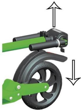
1. Hinteren Kotflügel hinunterdrücken und Lenkstange hochziehen
